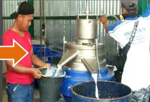
Pemekatan lateks kebun menjadi lateks pekat secara sentrifugasi atau pendidihan di UPPB/Gapoktan
